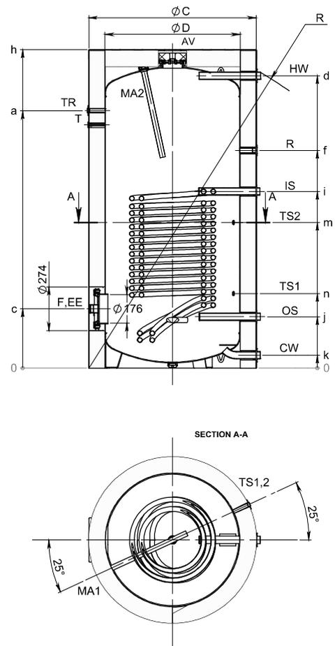
**Table 7** БОЙЛЕР РАЗМЕРИ | OVERALL DIMENSIONS | DIMENSIUNI TIP | ESPECIFICACIONES TÉCNICAS | TERMOACUMULADOR DIMENSÕES | BOILER ABMESSUNGEN | РАЗМЕРЫ БОЙЛЕР | РОЗМІРИ ДІМЕНЗІЇ | WYMIARY | SPLOŠNE DIMENZJE | DIMENSIONS GLOBALES | DIMENZIJE GRELNIKA VODE | ΣΥΝΟΛΙΚΕΣ ΔΙΑΣΤΑΣΕΙΣ |
